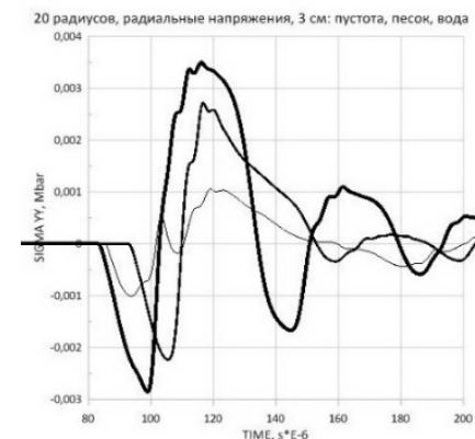
Рис. 2. Изменение радиальных напряжений в зависимости от времени в точке на расстоянии 20 радиусов шпура для различных наполнителей его инертным материалом: 1 – тонкая линия воздушный зазор, 2 – линия средней толщины – зазор, заполненный песком, 3 – жирная линия зазор, заполненный водой
