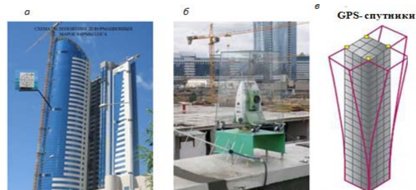
Рис. 1. Расположение контрольных марок на объекте (а); мониторинг здания с применением роботизированного электронного тахеометра(б); общая схема GPS-мониторинг ветрового воздействия на высотное здание (в)
