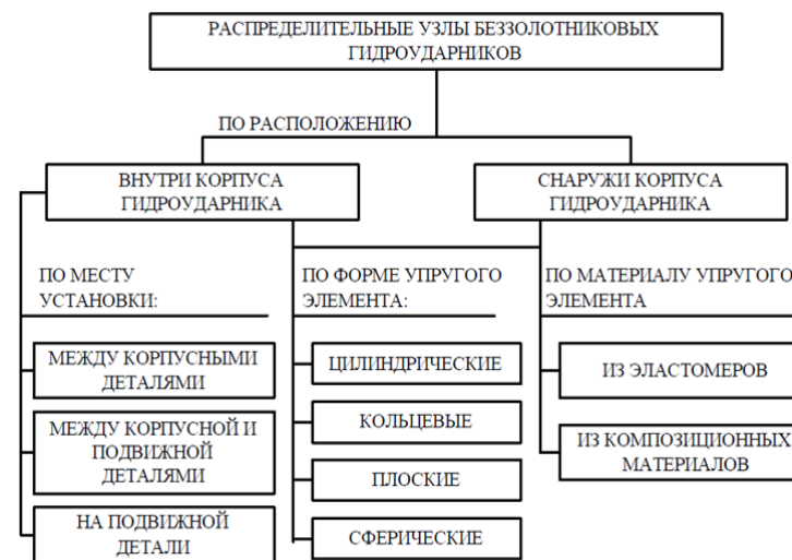
Рис. 1. Классификация распределительных узлов беззолотниковых гидроударников
