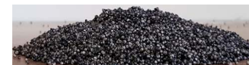
Рис. 6. Гранулит ИСУ-3У-1 (первый образец из СЗМ через 1 час 30 мин)
